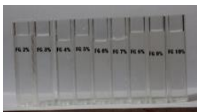
Gambar 3. Hasil Filtrasi Air Laut dengan komposit berpori 2% hingga 10% massa PEG
