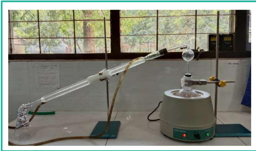
Gambar 5. Penyiapan destilasi untuk bioetanol
