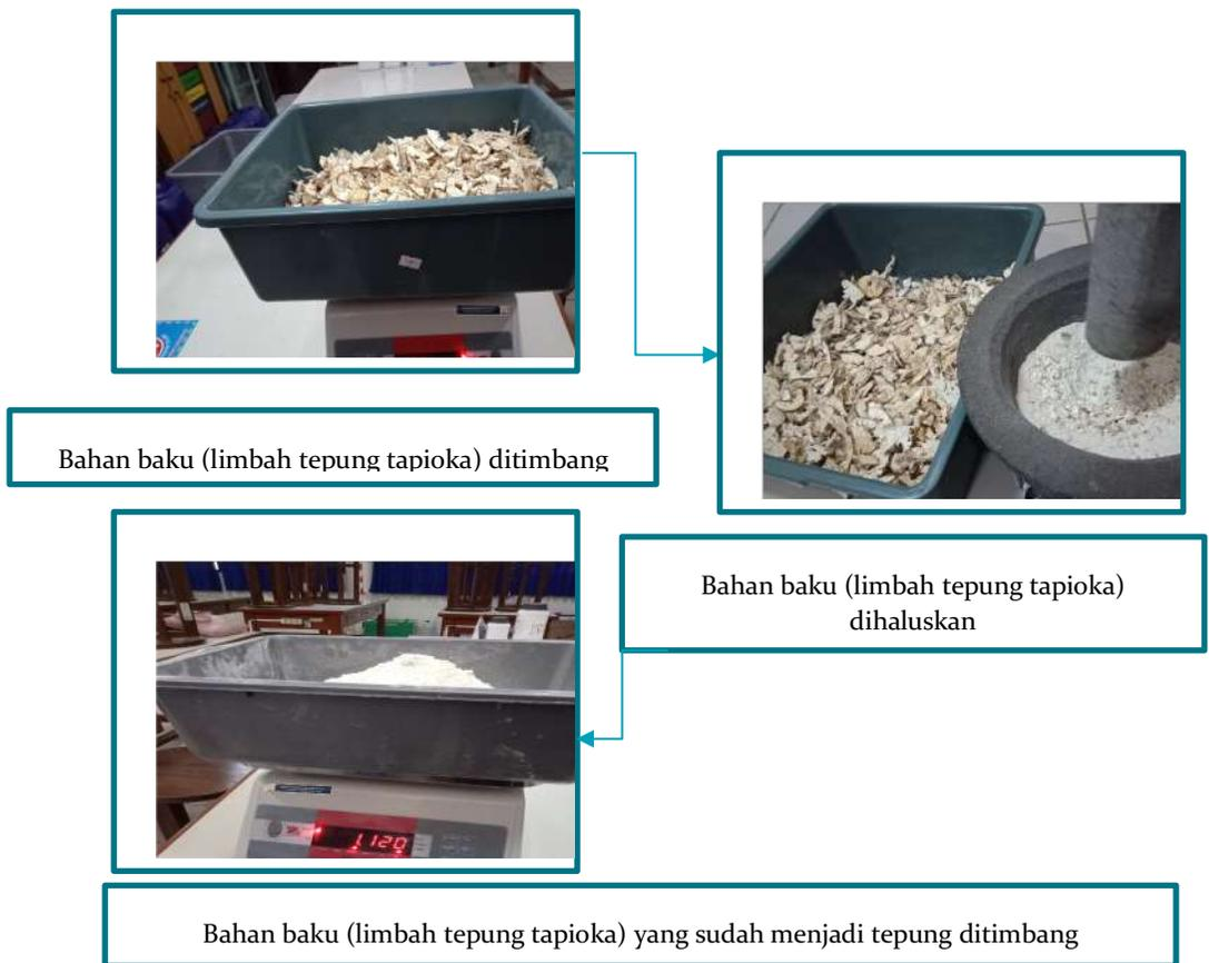
Gambar 2 Prosedur Persiapan bahan baku bioetanol
