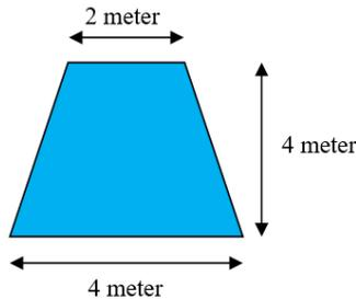
Gambar di atas adalah penampang tegak sebuah tanki yang terisi penuh dengan panjangnya 10 meter. Jika air harus dipompa setinggi 1 meter di atas puncak tanki. Berapa kerja yang dibutuhkan untuk mengosongkan tanki tersebut?
