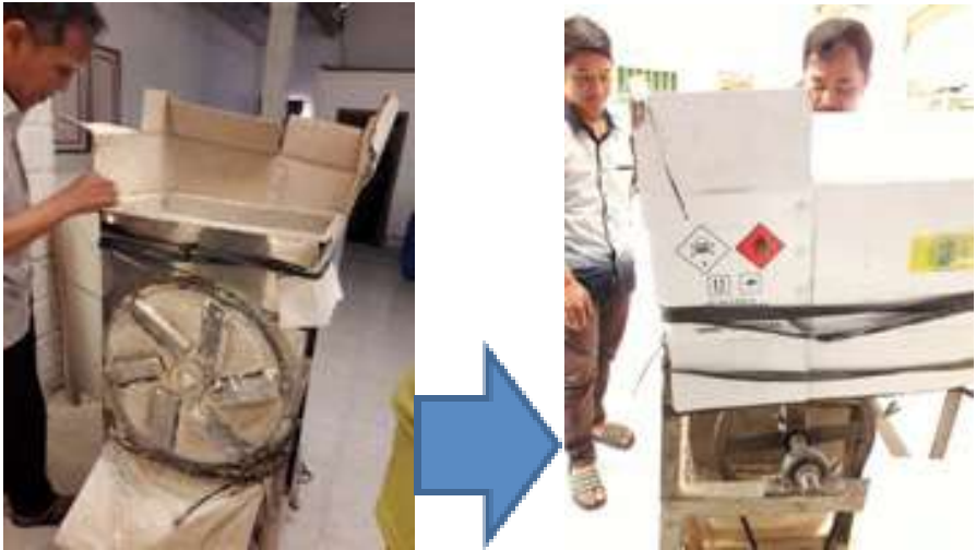
21a. Mulut mesin kurang dalam singkong sering terhambur 21b. Ditambah corong agar ubi yang hendak dislesi tidak terhambur
