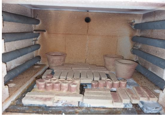
Gambar 8.12. Proses Sintering pada Spesimen Crucible
