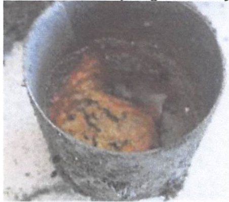
Gambar 2.4. Fracture pada Crucible karena Bereaksi dengan Logam yang Dileburkan (Ilias, 2018).
