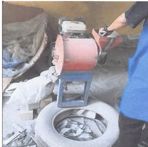
Gambar 2.10. Mesin Crusher untuk Limbah Evaporation Boats
