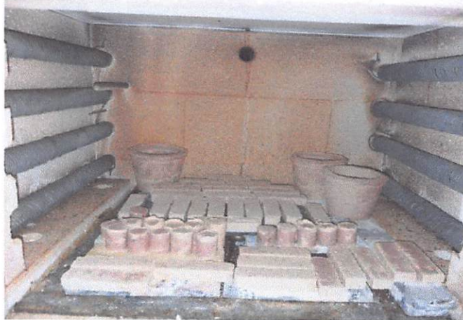
Gambar 2.17. Foto produk crucible dengan beda durasi pencampuran setelah proses sintering
