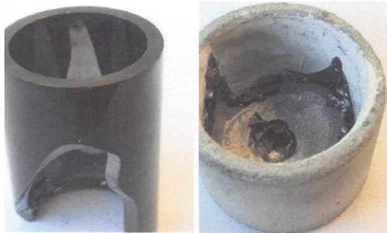
Gambar 2.2. Fracture pada Crucible karena Melt Wetting pada Crucible Berbahan (a) Glassy Carbon dan (b) Zirconia (Ilias, 2018)
