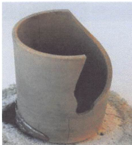
Gambar 2.2. Fracture pada Crucible karena Melt Wetting pada Crucible Berbahan (a) Glassy Carbon dan (b) Zirconia (Ilias, 2018)
