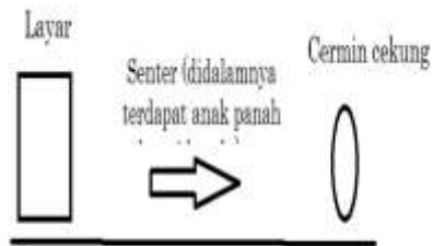
Gambar set percobaan pembentukan bayangan pada cermin cekung
