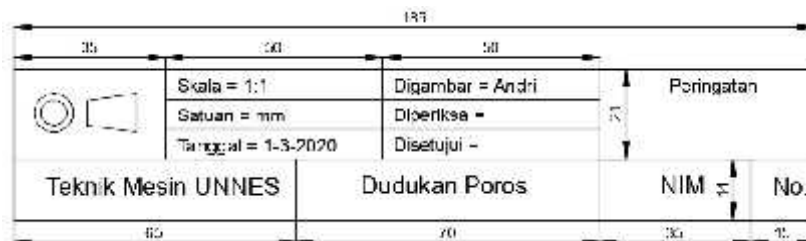
Gambar 47. Etiket gambar standar penunjukan proyeksi
