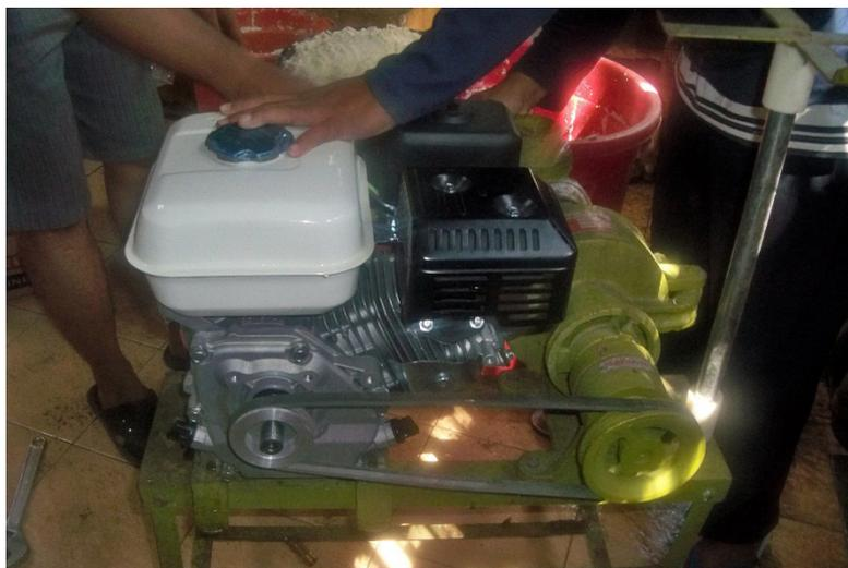
**Gambar 2. Mesin penggiling kedelai penggerak motor bensin.**
