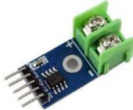
Gambar 3. 20 Modul Termokopel MAX6675
