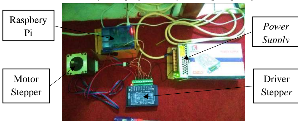
Gambar 3.26 Rangkaian Uji Coba Program
