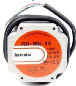
Gambar 3.8 Spesifikasi yang Terdapat pada Motor Stepper
