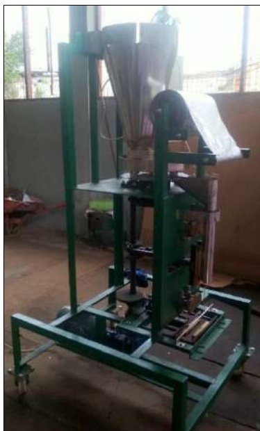
Gambar 3.48 Mesin Pengemas Produk Serbuk
