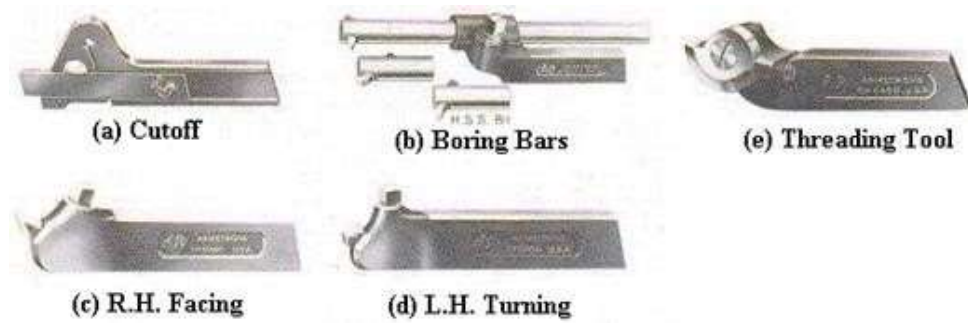
Gambar 2.8 Pemegang Pahat HSS, (a) Pahat Alur, (b) Pahat Dalam, (c) Pahat Rata Kanan, (d) Pahat Rata Kiri, dan (e) Pahat Ulir (Sumber : Widarto, 2008)
