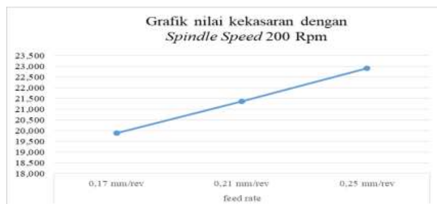
Gambar 4.2 Grafik nilai kekasaran dengan spindle speed 200 rpm.
