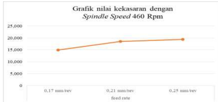
Gambar 4.3 Grafik nilai kekasaran dengan spindle speed 460 rpm.
