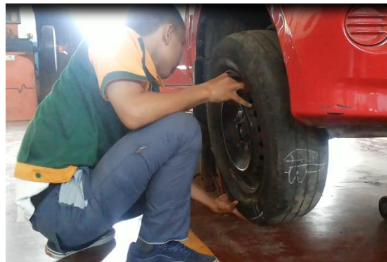
Gbr.4. pemasangan roda
