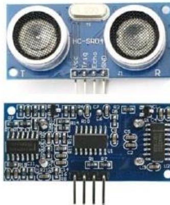
Gambar 4. Bentuk fisik sensor ultrasonik
