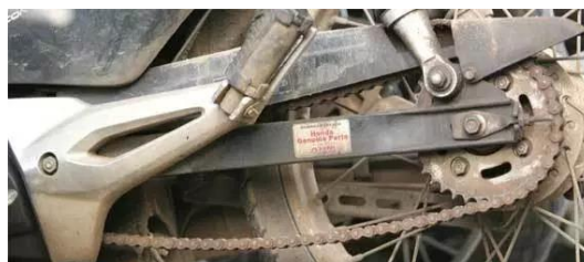
Gambar 1. Rantai Sepeda Motor Kendur
