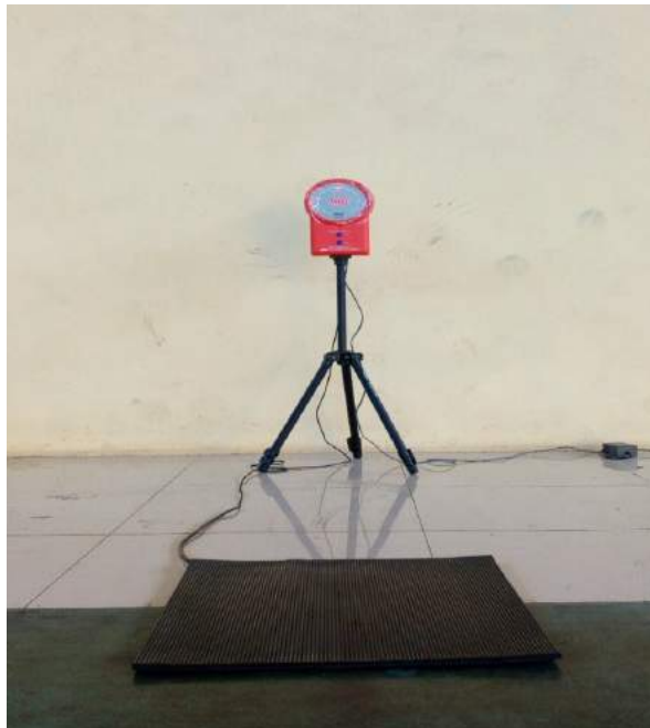
Gambar 5.1 Jump Power Meter untuk mengukur vertical jump (Sumber: Haryono & Pribadi, 2012)
