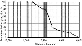
Gambar 2 Distribusi butiran tanah pada jarak 5 m
