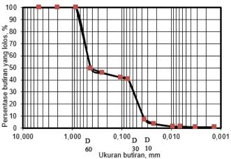
Gambar 1 Distribusi butiran tanah pada jarak 0 m
