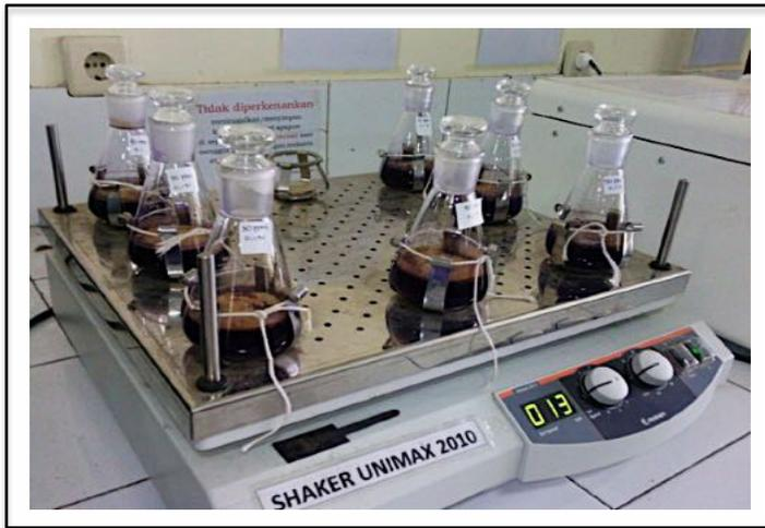
**Gambar 4.19.** Percobaan adsorpsi zat warna metil violet oleh serbuk kayu randu hasil reaksi dengan NaOH 0,3 N.
