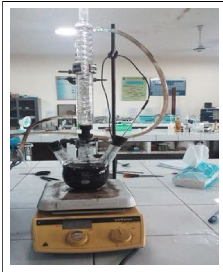
Gambar 6.2. Proses refluks abu layang menggunakan NaOH
