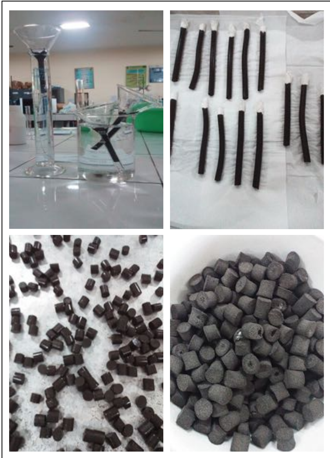
Gambar 6.3. Proses ekstrusi sederhana di laboratorium
