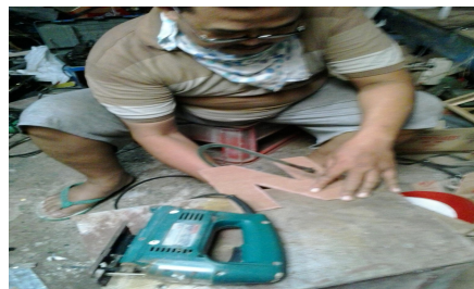
Gambar 4. Pembuatan kerajinan limbah akrilik (Menggunakan media gergaji kaca)
