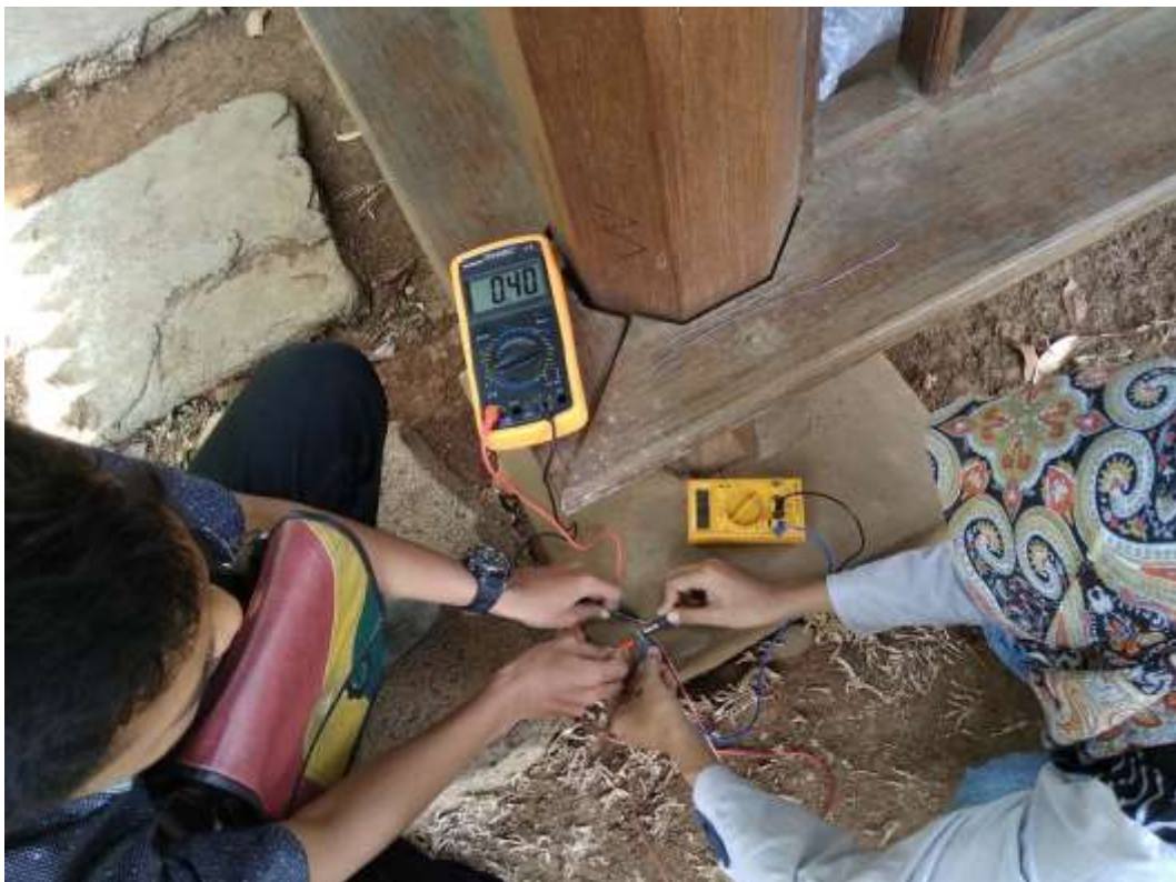
c. Pengukuran tegangan dan arus yang dihasilkan sel surya
