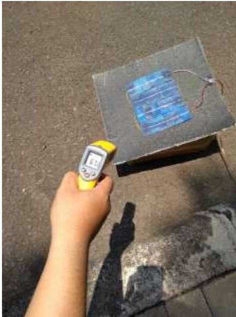
a. Pengukuran suhu sel surya
