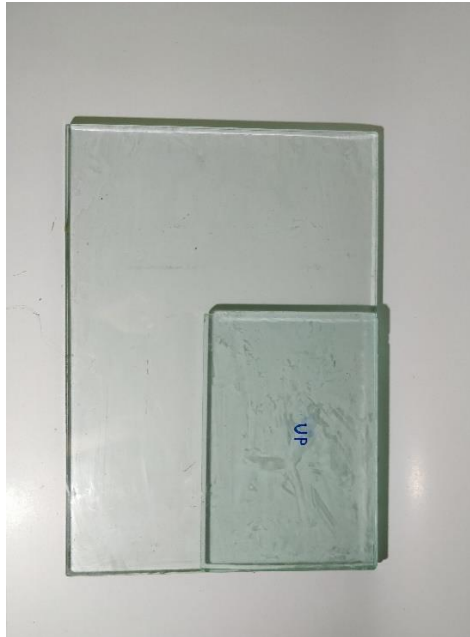
Gambar 3.7 Kaca dimensi 350 mm x 200 mm x 8 mm dan 199 mm x 139 mm x 10 mm
