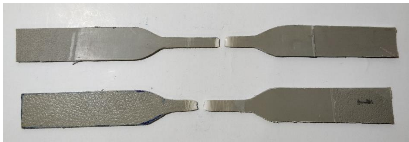
Gambar 4.3 Hasil pengujian tarik varian doortrim
