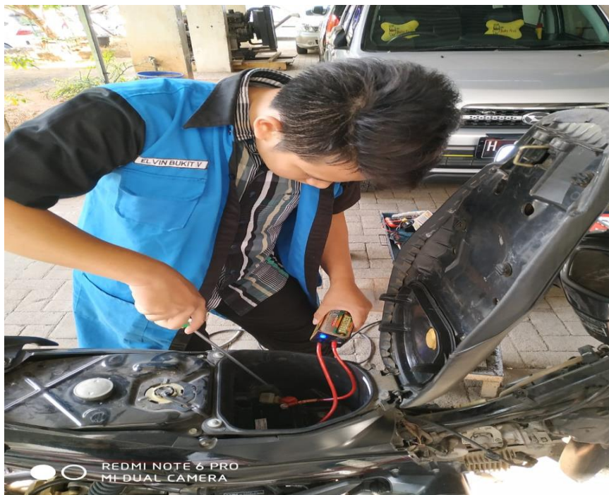
Gambar 5.2 Pemasangan Ignition Stabilizer Pada Baterai
