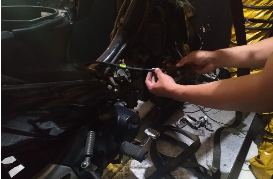
Gambar 5.1 Pemasangan Ignition Booster Pada Kabel Busi
