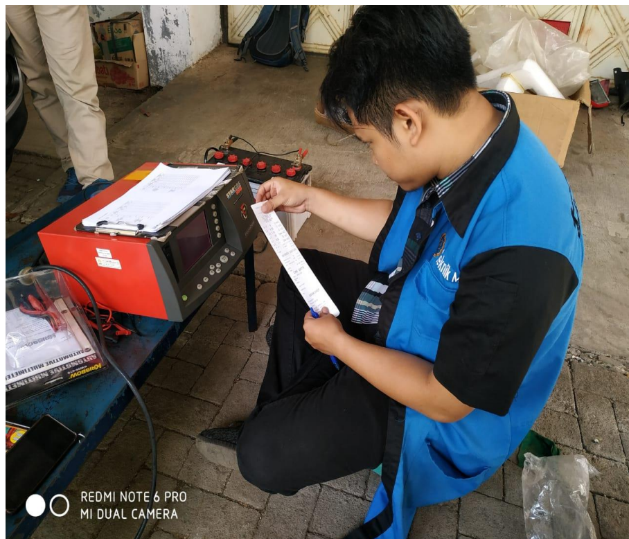
Gambar 5.6 Pembacaan Hasil Pengujian Emisi Gas Buang Menggunakan Gas Analyzer
