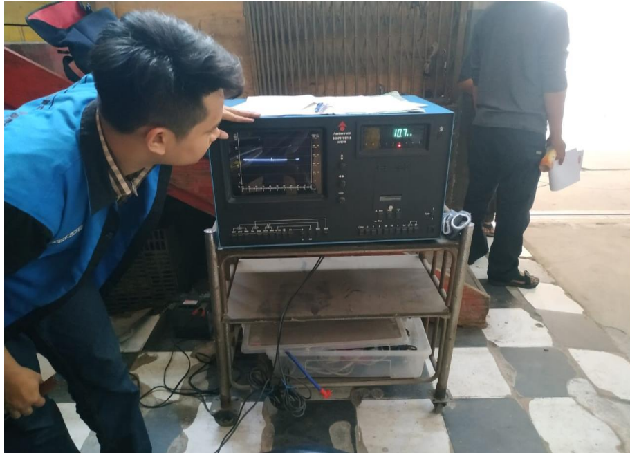
Gambar 5.3 Pembacaan Hasil Pengujian Tegangan Output Koil Menggunakan Scopetester
