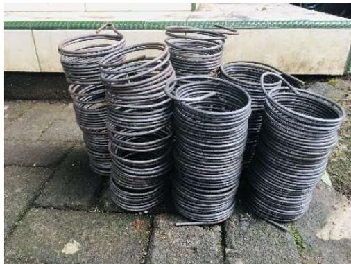
**Gambar 3. 2** Tulangan Baja Spiral Diameter 4,4 mm
