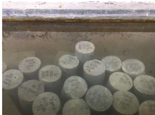
**Gambar 3. 7** Perendaman Beton dalam Bak Air
