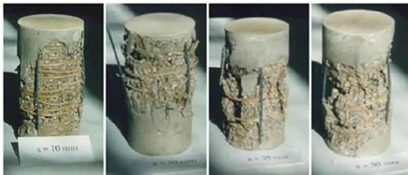
**Gambar 2. 5** Bentuk Benda Uji Setelah Diuji
