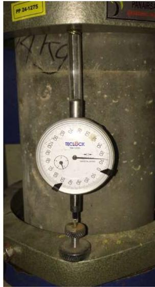
**Gambar 3. 10** Alat Manometer Pembaca Dial
