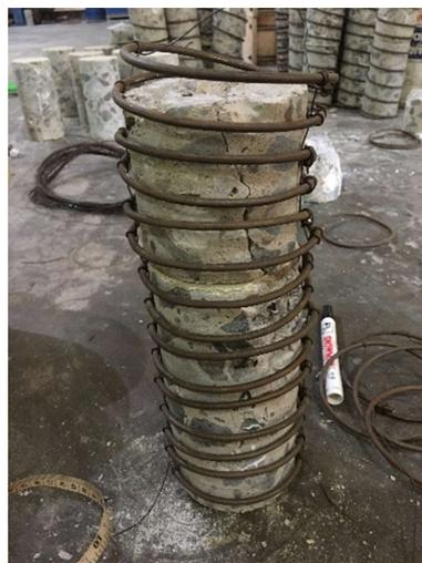
**Gambar 3. 5** Pemasangan Sengkang Spiral
