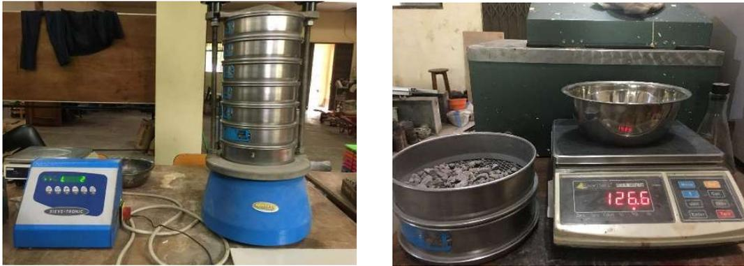
**Gambar 3. 4** Alat untuk Pengujian Pasir
