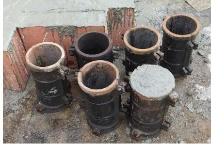
Gambar 3.4 Pembuatan Benda Uji Silinder Beton
