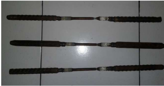
Gambar 3.3 Baut Yang Sudah Diuji Tarik
