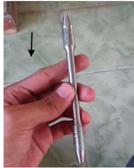
Gambar 3.2 Baut Angkur Yang Sudah Dibubut
