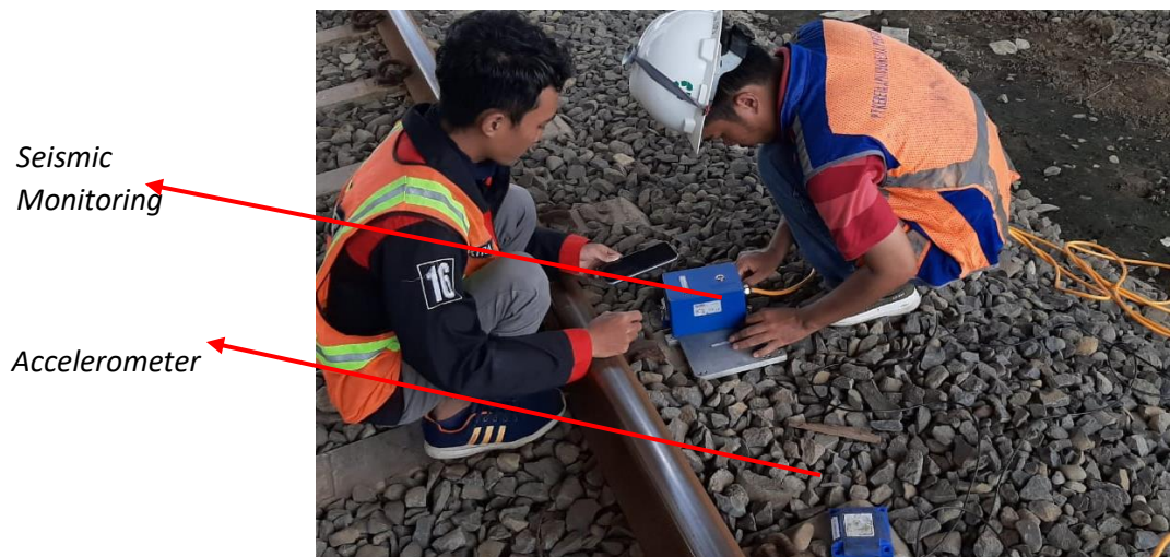
Gambar 3.9 Posis perletakan kedua sensor di bantalan saat kereta melintas
