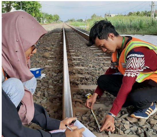
Gambar 3.13 Pengukuran dimensi rel
