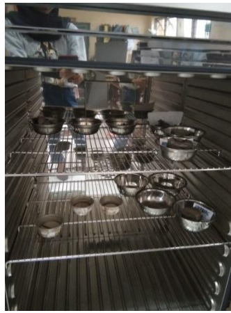
Gambar 3. 2. Proses pengovenan sampel tanah
