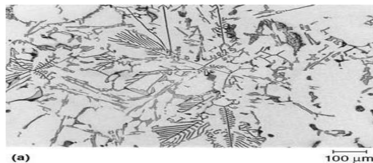
Gambar 2.8 Hypoeutectic aluminum-silicon alloy (Sumber: Stefanescu dan Ruxanda, 2004:1)
