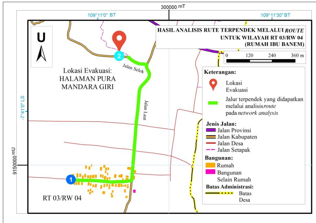
Gambar 63. Hasil Analisis Rute Terpendek Menuju Lokasi Evakuasi Melalui Operasi Route Untuk Masyarakat RT 03/RW 04
