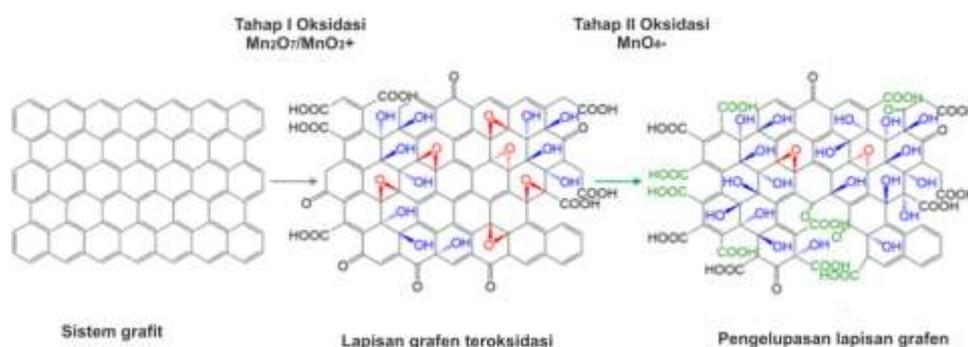
**Gambar 4.6** Tahapan proses oksidasi GO (Kang *et al.*, 2016).
