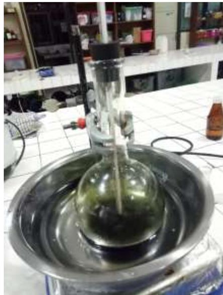
**Gambar 4.4** Proses oksidasi GO setelah penambahan  $\text{KMnO}_4$
