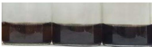
**Gambar 4.8** Perubahan warna GO setelah direduksi
