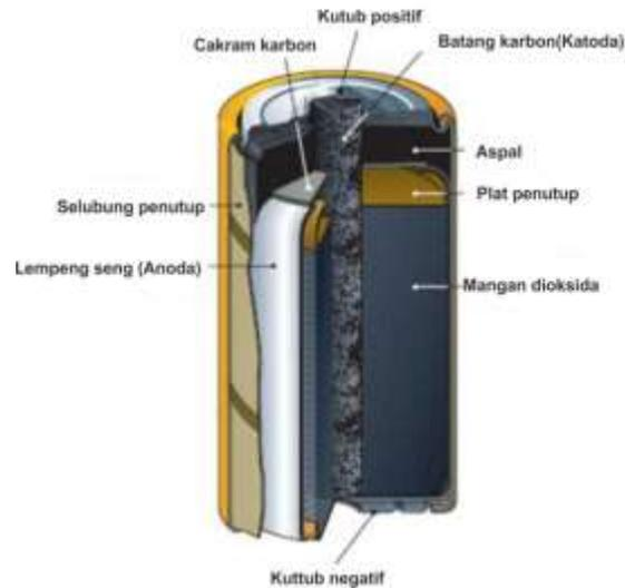
**Gambar 2.1** Struktur Baterai Seng Karbon (Fricke, 2007).
