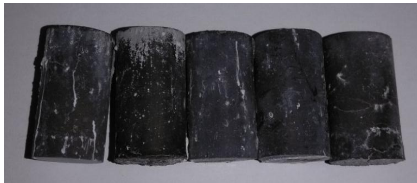
Gambar 4. 11. Hasil Sampel Geopolimer setelah dilakukan perendaman.
