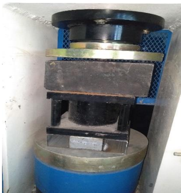
Uji Kuat Tekan
