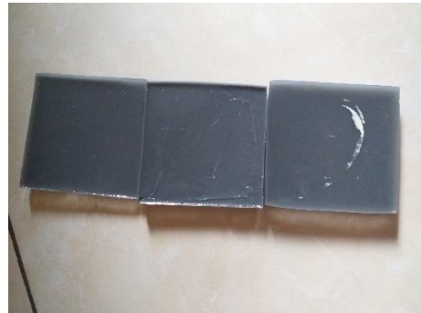
Gambar 10. Hasil cetakan dari komposit polyesther
