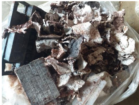
Gambar 3. Sekat antar lembar timbal pada aki
