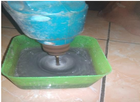
Gambar 9. Proses pencampuran resin dengan timbal
