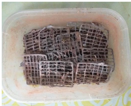
Gambar 5. Komponen yang ada di dalam lembar aki setelah di tumbuk
