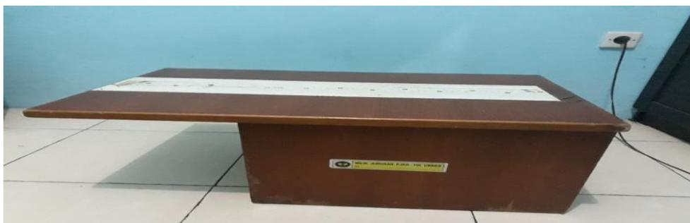
Gambar 3.4 Alat Ukur Kelentukan punggung (*Flexiometer*)
