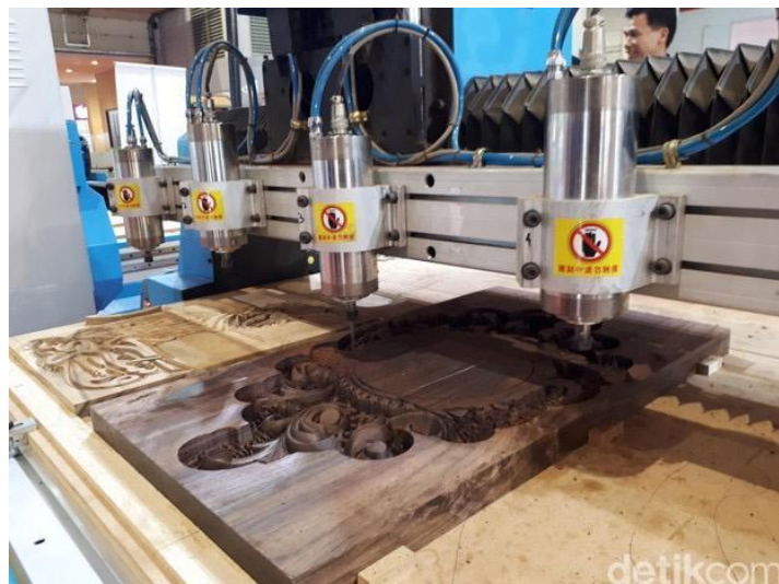
Gambar 4. Alat Pencetak Ukiran Sumber: Detik.com, 2017
