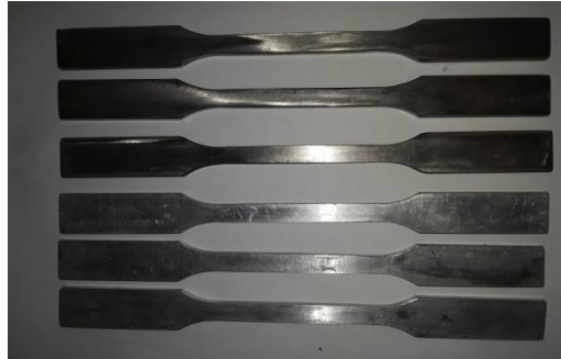
Gambar 3.2 Spesimen Uji Tarik Material Stainless Steel 304 dan Aluminium 6061
