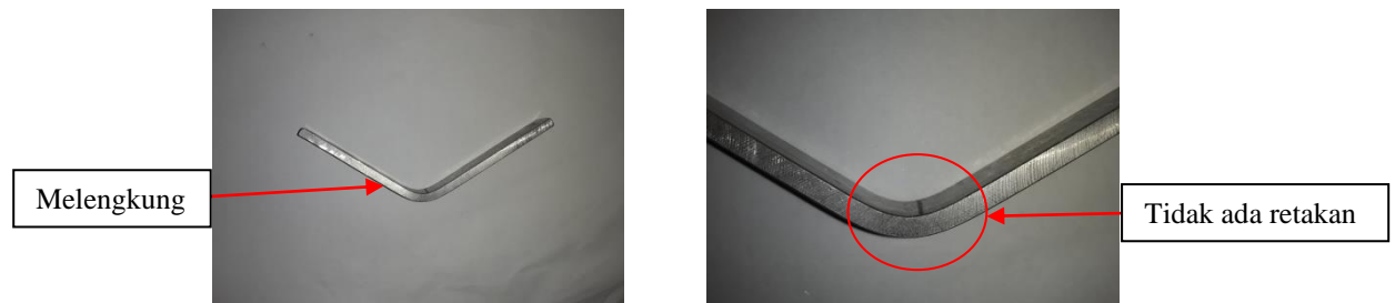
Gambar 4.6 Spesimen Hasil Pengujian Bending Bahan Aluminium 6061
