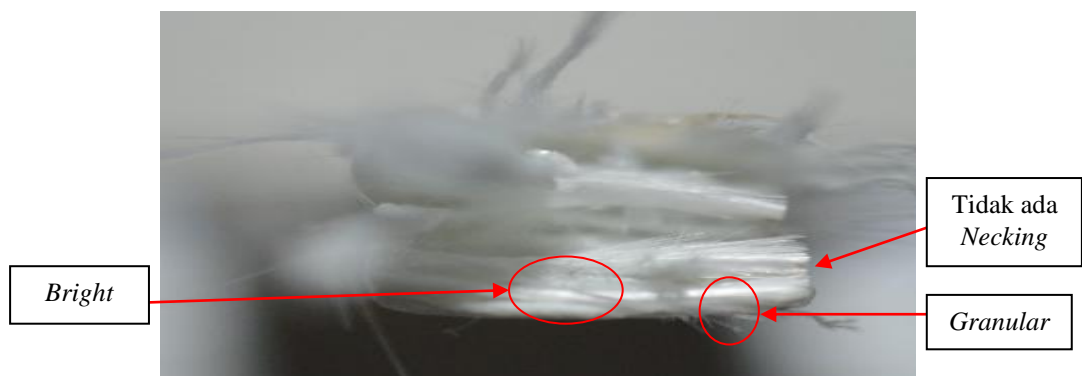
Gambar 4.4 Spesimen Hasil Pengujian Tarik Bahan Komposit fiberglass Diperbesar 6x
