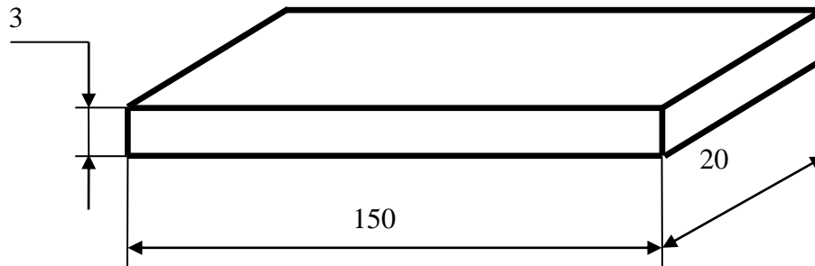
Gambar 2.6 Dimensi Spesimen Uji Bending Stainless Steel 304 dan Aluminium 6061 (Naharuddin, 2015:552).
