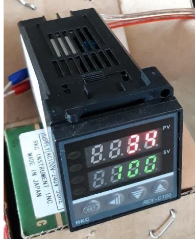
Gambar 3.5. Pengontrol Temperatur (Dokumentasi Pribadi)
