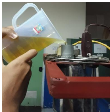
Gambar 3.4. Alat Proses Transesterifikasi di lab TUK UNNES (Dokumentasi Pribadi)
