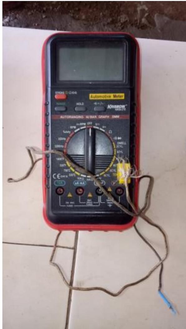
Lampiran 5. *Thermocouple* dan *multitester* alat untuk mengukur temperatur oli
