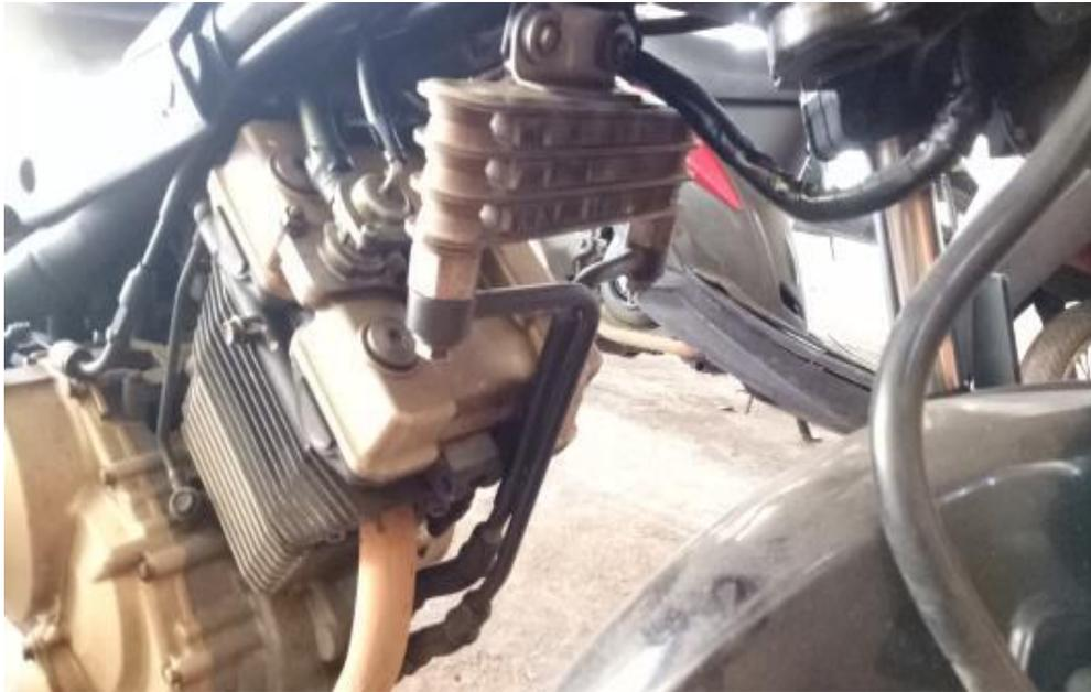
Lampiran 2. Pengujian temperatur oli dengan menggunakan *oil cooler* standar
