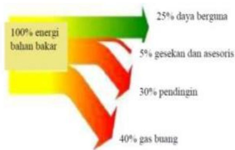
Gambar 2.3. Keseimbangan Energi Pada Motor Bakar.
