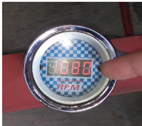
Gambar 3.3 Tachometer Digital (Dokumentasi Pribadi)
