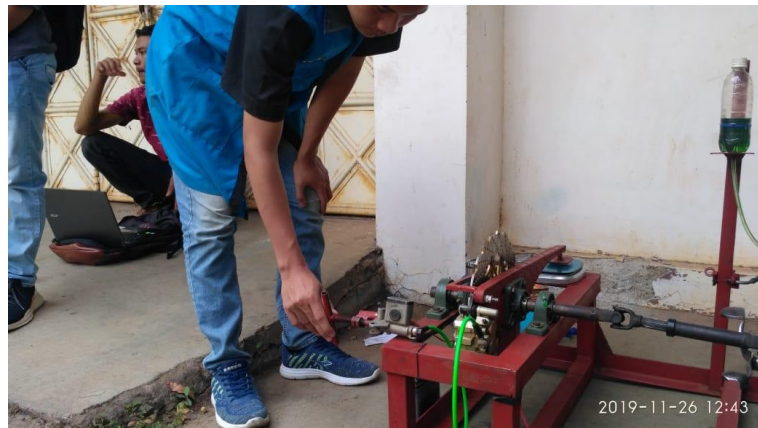
Gambar 7. Mengatur Pengereman Untuk mencapai RPM yang diinginkan
