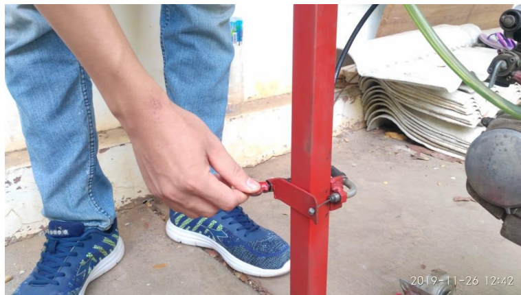
Gambar 6. Putar gas sampe throttle terbuka penuh
