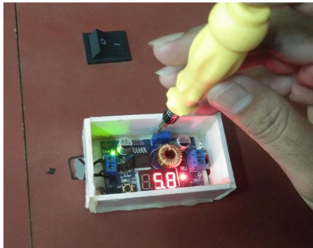
Gambar 4. 15 Penyetelan tegangan converter step down pompa
