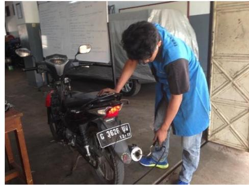
Pemasangan Probe Gas Analyzer
