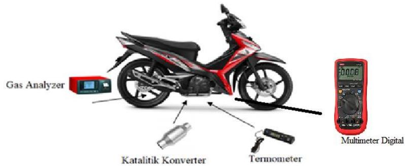
Gambar 3.4 Skema Peralatan Uji
