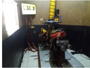
Persiapan pengujian performa mesin
