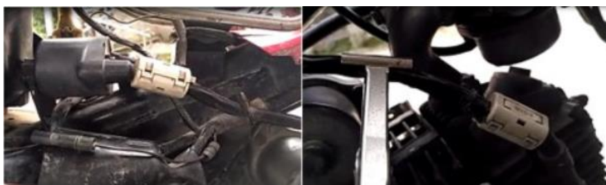
Gambar 2.6. Pemasangan ferrite bead pada kabel busi
