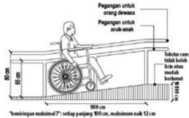
Gambar 4.40 Ramp Bagi Disabilitas
