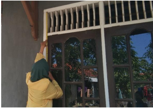
Pengukuran luas ventilasi ruangan
