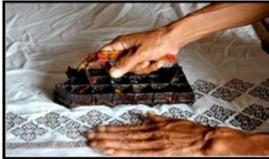
Gambar 6. Membuat Pola Batik Menggunakan Cap (Sumber : www.kratonpedia.com )
