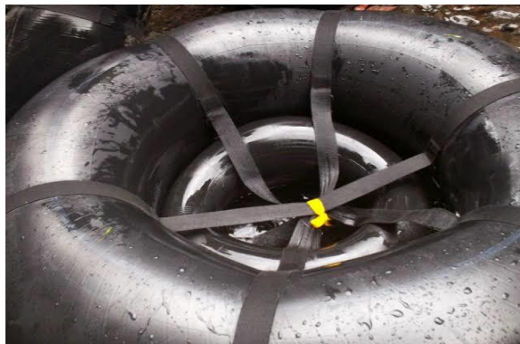
Gambar 2.1 Ban yang sudah dilengkapi dengan webbing
