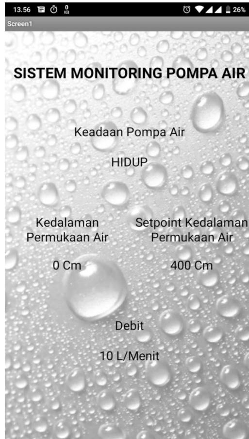
Gambar 4.5 Tampilan Pengukuran Kecepatan Aliran Air Pada *Smartphone*
