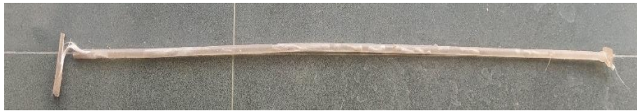
Gambar 3. 3 Komposit shaft dengan massa serat 15 gram
