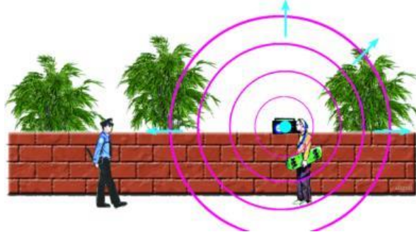
Gambar 2.5. Pendengar yang bergerak menuju sumber bunyi yang tidak bergerak akan mendengar frekuensi yang lebih tinggi daripada frekuensi sumber bunyi. (Kanginan, 2016)
