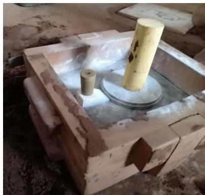
Gambar 3.5. Foto pola variasi saluran penambah silinder
