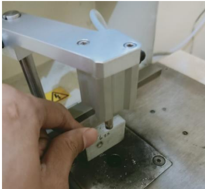
Pengujian komposisi kimia dengan Spectrometer
