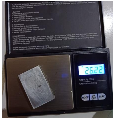
Penimbangan berat spesimen pada timbangan digital saat kering dan saat melayang pada gelas
