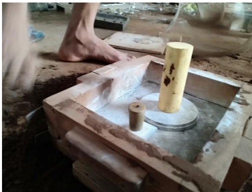
Penyusunan saluran pengecoran
