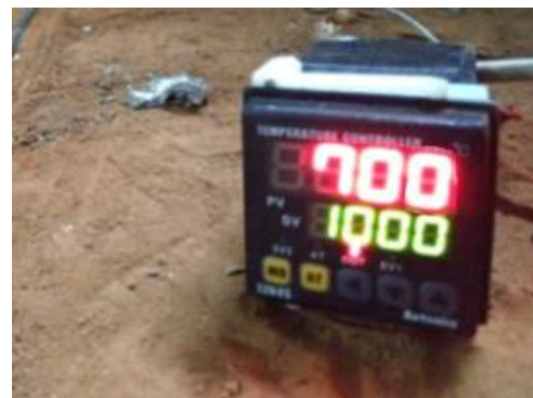
Suhu Peleburan dari Thermocouple
