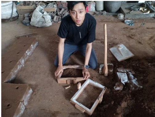
Pembuatan Cetakan dari pasir
