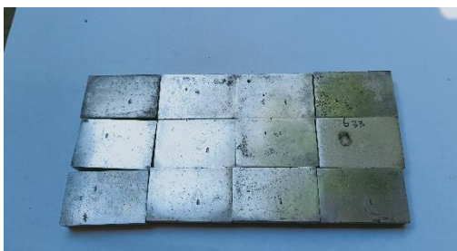
Hasil Pengecoran yang sudah di Mechining sesuai ukuran spesimen
