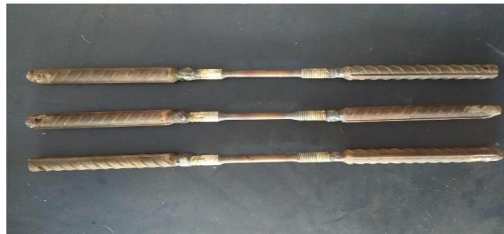
Gambar 3.6. Spesimen kuat tarik (bahan) baut angkur
