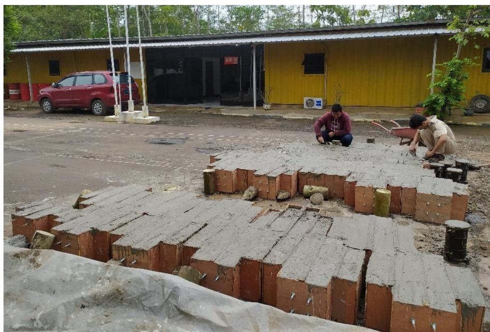
Gambar 3.12. Pengecoran ke Bekisting Benda Uji Berbentuk Balok T
