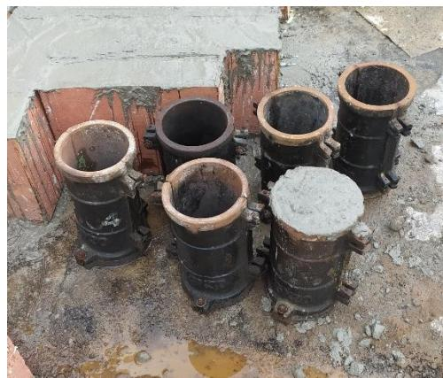
Gambar 3.9. Pembuatan Benda Uji Silinder Beton
