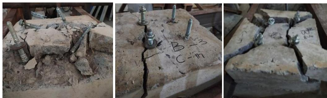
Gambar 4.7. Kegagalan Pasca Pengujian *Cast In Place*
