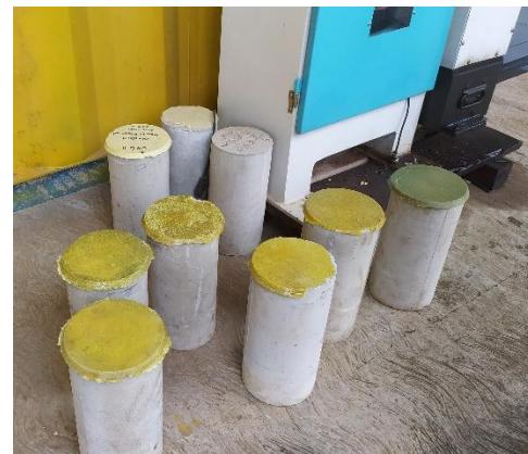
Gambar 3.10. *Capping* Pada Benda Uji
