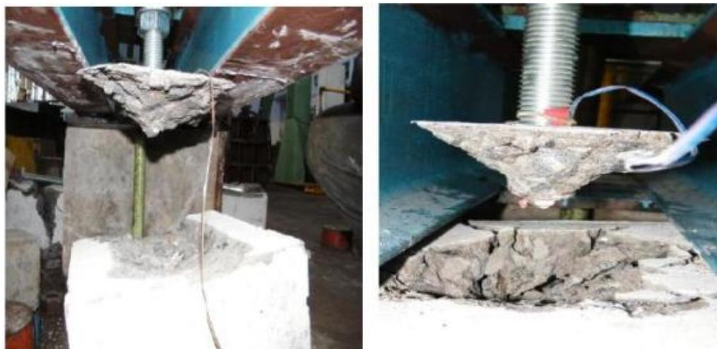
Gambar 2.4. Pola keruntuhan beton membentuk sudut  $45^\circ$  dengan kedalaman baut 50 mm
