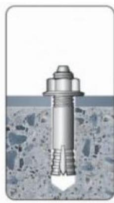
Gambar 2.12. Angkur tipe ekspansi (*hammer drive anchor*)
