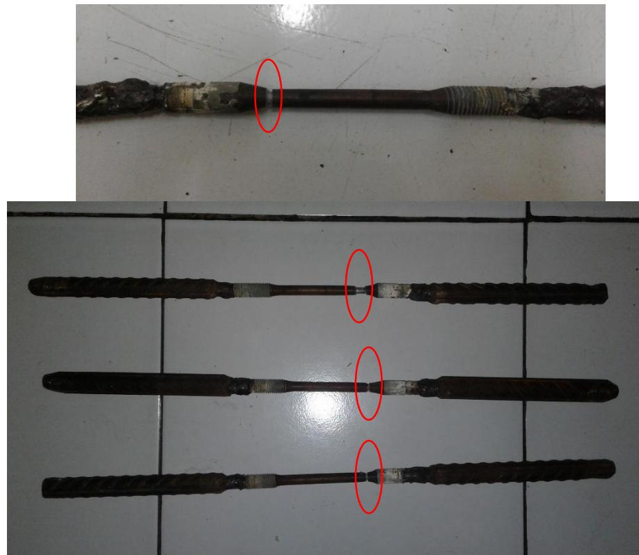
Gambar 3.8. Pengujian Bahan Baut Angkur (Uji Tarik)
