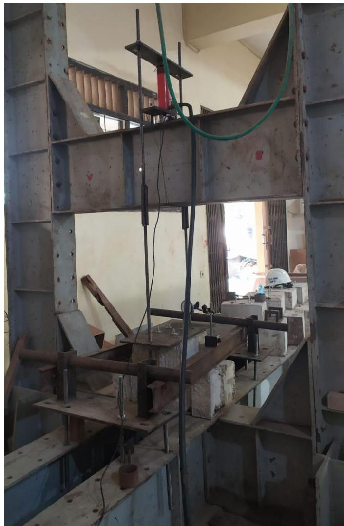
Gambar 3.15. Pengujian Tarik Angkur ke Beton
