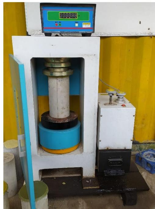
Gambar 3.11. Pengujian Kuat Tekan Silinder Beton
