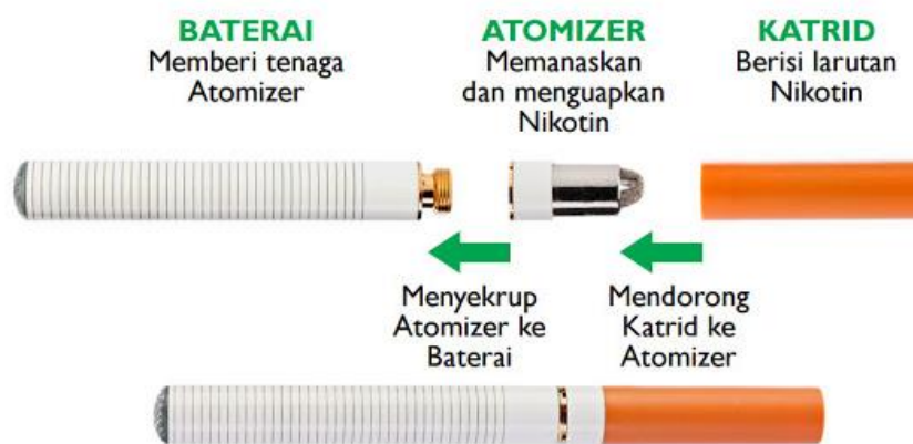
Gambar 2.1 Struktur Rokok Elektrik (BPOM, 2015).
